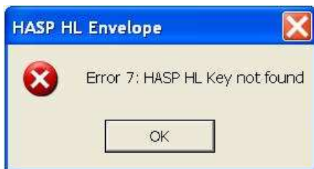
Rys. 1. Okno dialogowe z komunikatem o błędzie, który pojawia się podczas próby uruchomienia programu KALKUL bez klucza HASP w porcie USB.
